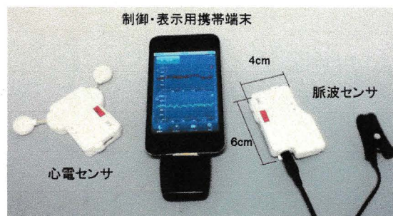
図 4 ウェアラブル血圧センサのプロトタイプ
